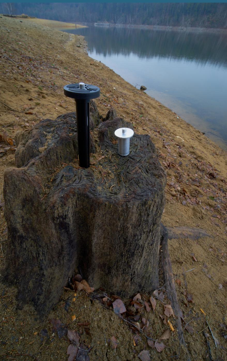
**Výměnné stativové slouppky.** Vlevo standardní sloupek, vpravo zkrácená verze, vytočená šikovným soustružníkem z tyče hliníkové slitiny.
