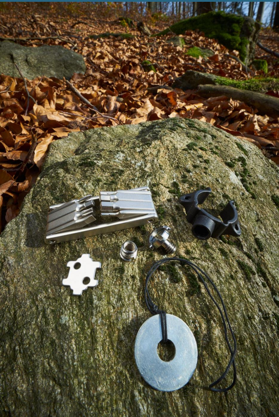
**Drobnosti ke stativu z mého fotobatohu.** Zleva sada inbus klíčů a plochých, křížových i hvězdičkových šroubováků. Pod ní plochý klíček na montáž redukce stativových šroubů (z 1/4" na 3/8"), vedle redukce stativového šroubu a rezervní stativový šroub 1/4" pro rychloupínací destičky. Dole plochá podložka ze železářství k utažení stativových šroubů s drážkou. Vpravo nahoře plastový klíček od Manfrotto k dotahování matic nohou stativu.
