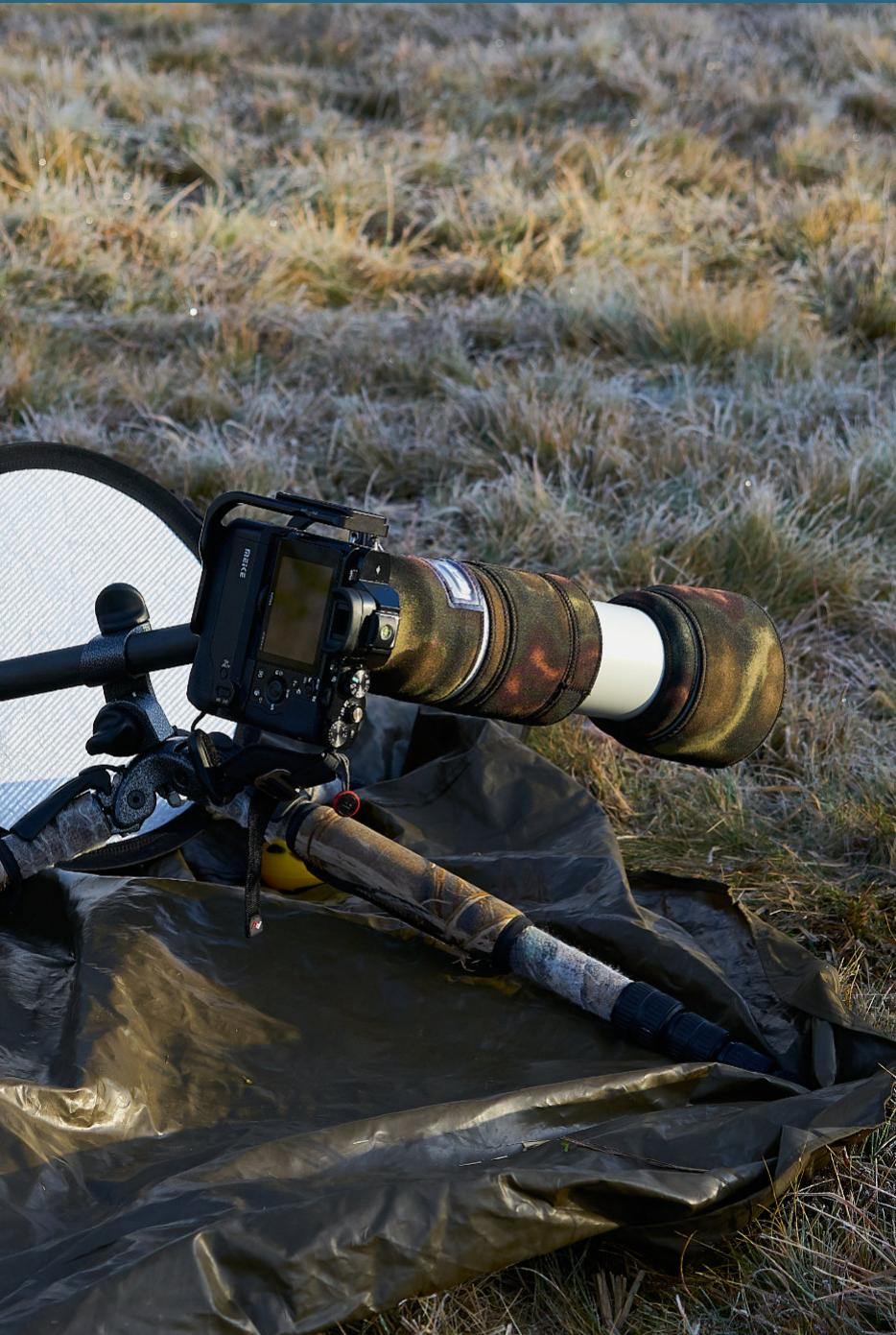
**Torzní úhel** udává rozdíl mezi polohou optické osy objektivu v klidu a v krajní poloze při rozkmitání objektivu. A většina výrobců o tomto parametru cudně mlčí. Raději...
