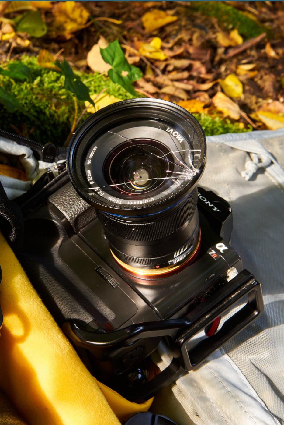
**Bezprostředně po nehodě.** Rozbitý magnetický UV filtr od VFFOTO ochránil vlastní objektiv, L-destička od Really Right Stuff zase tělo bezrcadlovky Sony. Takže vše dopadlo relativně dobře.
